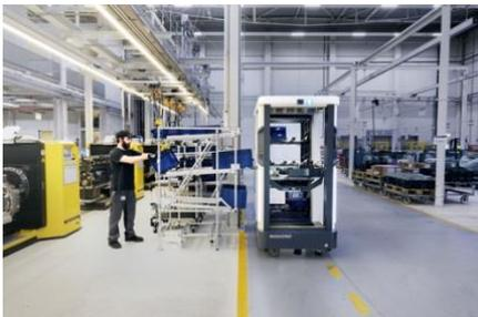
Bildunterschrift: Der mobile Roboter SOTO bringt Nachschub vollständig autonom vom Lager an die Linie.
